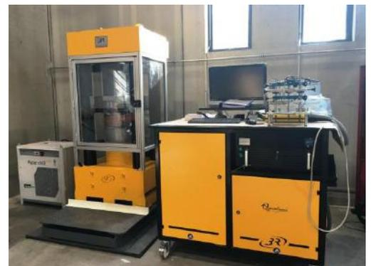
*Machine d'essai de compression 4000kN*
