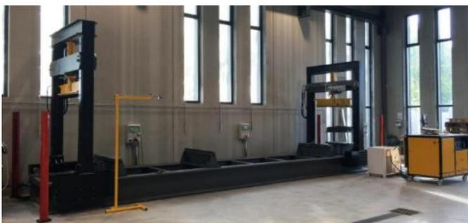
*Banc pour essai de flexion sur poutre 2x300kN*
