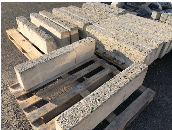
Les bordures utilisent du béton bas carbone et des déchets de verre issus de l'économie circulaire
